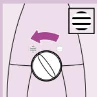
**3** Kies de zachte stand voor dagelijkse reiniging (alleen bij type HP 5252 en HP5253).
