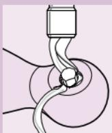
**3 Motor milinde kalan temizleme artıklarının durulanması için Visapure'u düğmesinden açın.**
