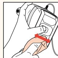
*Stellen Sie das Gerät zum Reinigen der Rollen auf Position 1, bedecken Sie die Saugöffnung an der Unterseite mit Ihrem Daumen, so daß die Rollen sich bewegen, und wischen Sie sie dann mit einem feuchten Tuch ab.*
