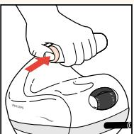
Lorsque vous avez atteint le point le plus haut, coupez l'aspiration en appuyant sur le bouton Vacu-stop et retirez l'appareil de la peau. Le bouton Vacu-stop est particulièrement utile lorsque vous utilisez l'appareil aux niveaux d'intensité les plus élevés.
