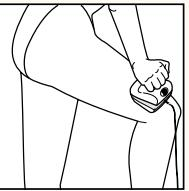
Plaats het apparaat voorzichtig op de huid, even boven de knie. Werk altijd slechts in één richting: altijd van beneden naar boven (naar het hart toe).
