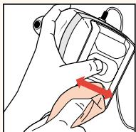
*Per pulire i rulli, selezionate il Livello 1, coprite con il pollice l'apertura di aspirazione per farli ruotare, e puliteli con un panno inumidito, come mostra la figura.*
