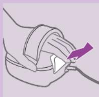
**11** Quando terminar uma passagem, solte o interruptor do sistema Vacumotion para parar o aparelho.
