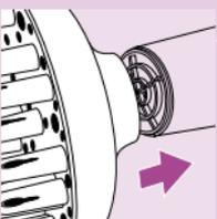
■ Difüzörü cihaza bastırarak takabilir ve çekerek cihazdan çıkarabilirsiniz.
