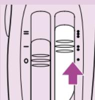
**3** Välj önskat luftflöde genom att trycka på | för ett mildt luftflöde. Slå över till || för ett starkare luftflöde.
