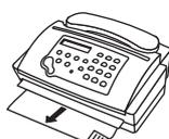
Depois de ter decorrido o número de sinais de chamada programado, a recepção de fax é automaticamente ligada. Um emissor que não tenha deixado qualquer mensagem no atendedor de chamadas será conectado com o aparelho de fax.
