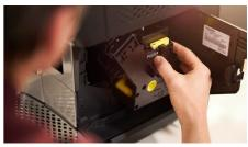
Die Brühgruppe ist das Herz jedes Kaffeevollautomaten und sollte regelmäßig gereinigt werden. Die herausnehmbare Brühgruppe ermöglicht Ihnen eine gründliche Reinigung, indem Sie sie einfach unter fließendem Wasser abspülen können.
