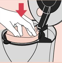
**1** Do držáku vložte papírový filtr (typ 1x4 nebo No.4).
