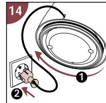
Fissate il cavo alla lunghezza desiderata premendolo nella fessura posta sulla parte posteriore dell'apparecchio.
