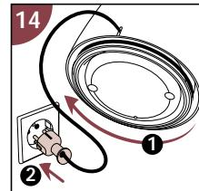
Presionándolo en la ranura de la parte trasera del aparato, fijen el cable de red a la longitud requerida
