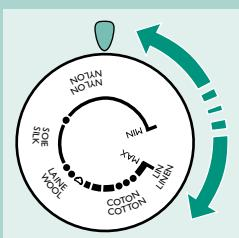
**3** Gire el dial de la temperatura hasta ponerlo en la temperatura de planchado adecuada.
