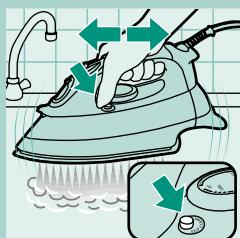
Repita el proceso de limpieza de la cal si quedasen aún muchas impurezas en la plancha.
