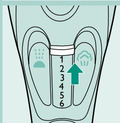
**1** Mettete il regolatore di vapore sulla posizione O (=Vapore escluso).
