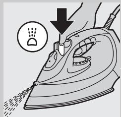
За премахване на упорити гънки при всяка температура
