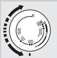
**1** Novietojiet gludekli uz tā pēdas un uzstādiet temperatūras regulatoru uz nepieciešamo gludināšanas temperatūru, griežot to uz atbilstošo pozīciju.
