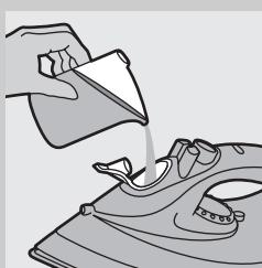
**4** Înclinați fierul și umpleți rezervorul de apă până la nivelul maxim.
