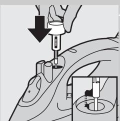
**I** Ielieciet tvaika vadības adatu atpakaļ, ievietojot adatas galu tieši atveres centrā, un iestipriniet spraugā mazo izvirzījumu, kas atrodas adatas sānā. Pagrieziet tvaika vadības pogu pozīcijā O.
