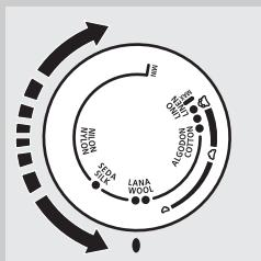
**1** Položte žehličku na zadní stranu a otočením regulátoru teploty nastavte požadovanou teplotu pro žehlení.
