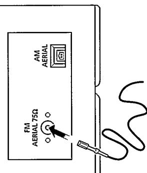
Ligue o cabo de antena FM fornecido ao terminal FM 75 Ω. Oriente a antena FM na posição que proporcione a melhor recepção de frequência modulada. Para optimização da recepção FM estéreo ligue a antena FM externa ao terminal FM 75 Ω, usando um cabo coaxial de 75 Ω.
