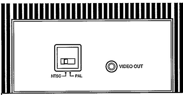
A leitura de CD vídeo requer a ligação do VIDEO OUT do sistema ao VÍDEO IN do televisor com um cabo de retenção fornecido. Selecione NTSC ou PAL em função do sistema de difusão de televisão que utiliza.
