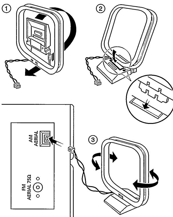
Ligue a antena de quadro fornecida ao terminal de antena AM. Oriente a antena de quadro AM na posição que proporcione a melhor recepção de amplitude modulada.
