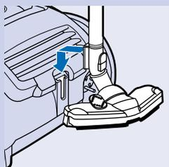
**1** 将吸尘嘴上的夹片插入插槽中，您可以将硬管放置妥当。
