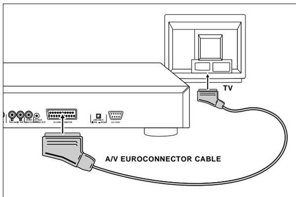
Anschluss an ein Fernsehgerät mit Euro-A/V-Anschluss.
