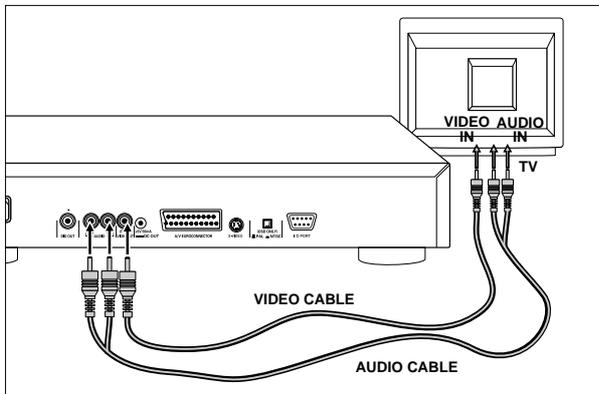
Anschluss an ein Fernsehgerät mit video-(CVBS bzw. FBAS)-buchse.
