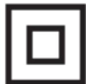
Dieses Symbol bedeutet, dass es sich um ein Gerät der Klasse II handelt. Der Adapter ist zweifach isoliert (Klasse II).
