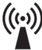
Das bedeutet, dass das Gerät nicht ionisierende Strahlung abgibt. Alle Geräte, die über einen HF-Sender verfügen oder elektromagnetische HF-Energie verwenden, müssen mit diesem Symbol gekennzeichnet sein.
