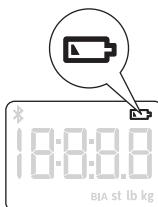
Dit apparaat heeft een 'batterij bijna leeg'-indicatie. Wanneer het batterijniveau onder de benedengrens komt, wordt het 'batterij bijna leeg'-pictogram weergegeven, waarna het apparaat binnen 4 seconden wordt uitgeschakeld.
