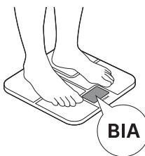
**4** De BIA-meting wordt gestart (bij een meting op blote voeten).
