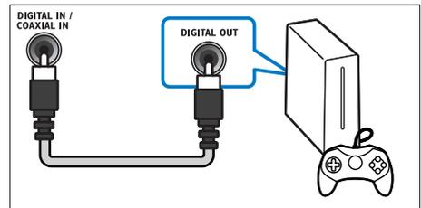
1 Schließen Sie den **COAXIAL**-Anschluss auf dem linken Lautsprecher dieses Produkts mit einem Koaxialkabel an den **COAXIAL / DIGITAL OUT**-Anschluss eines Fernsehers oder eines anderen Geräts an.
