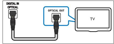
Schließen Sie den **OPTICAL**-Anschluss auf dem linken Lautsprecher dieses Produkts mit einem optischen Kabel an den **OPTICAL OUT**-Anschluss eines Fernsehers oder eines anderen Geräts.
