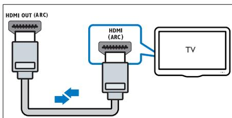
1 Verbinden Sie den **HDMI ARC**-Anschluss am linken Lautsprecher über ein Hochgeschwindigkeits-HDMI-Kabel mit dem HDMI (ARC)-Eingang am Fernseher:
