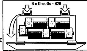
**Nota:** A alimentação por pilhas é desligada quando o aparelho é ligado à corrente eléctrica.
