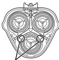
刃は3つとも○印の位置に外刃の突起部がくるようにセットしてください。
