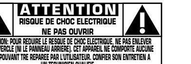
Cet «éclair à pointe de flèche» indique qu'un matériau non isolé, situé à l'intérieur de l'unité, risque de provoquer un choc électrique. Pour la sécurité de chacun, nous vous prions de ne pas retirer le boîtier de ce produit.
