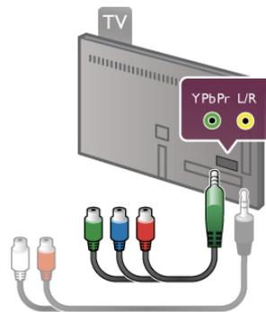
Utilize o cabo adaptador YPbPr fornecido para ligar o seu dispositivo. Faça corresponder as cores (verde, azul, vermelho) do conector YPbPr com as fichas do cabo quando ligar.
