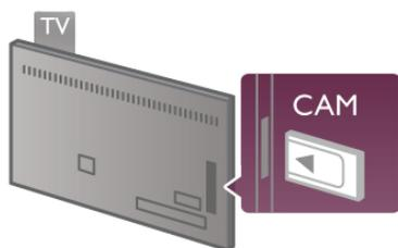
Utilize a ranhura da Interface Comum no lado esquerdo do televisor para introduzir o cartão CAM\*. Introduza-o totalmente com cuidado e deixe-o permanentemente na ranhura. A activação do CAM pode demorar alguns minutos. A remoção do CAM irá desactivar o serviço de emissão no televisor.
