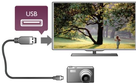
Se a lista de conteúdos não for apresentada automaticamente, prima **SOURCE**, seleccione **USB** e prima **OK**. Pode ser necessário definir a sua câmara para transferir o conteúdo através de PTP (Picture Transfer Protocol - Protocolo de Transferência de Imagens). Leia o manual de instruções da câmara fotográfica digital.
