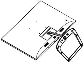
2. 固定クリップを押して、ベーススタンドをベース支柱から取り外します。
