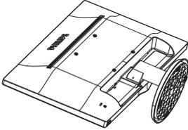
2. 固定クリップを押して、ベーススタンドをベース支柱から取り外します。
