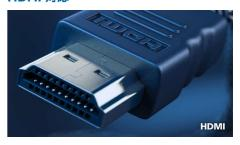
HDMI 対応デバイスは、High-Definition Multimedia Interface (HDMI) の入力を受け付けるために必要なすべてのハードウェアを装備しています。1 本の HDMI ケーブルを通じて、PC または AV の任意のソースから高品質のデジタルビデオとオーディオを送信することが可能になります(セットトップボックス、DVD プレイヤー、A/V 受信機、ビデオカメラを含む)。
