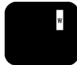
Três subpixels adjacentes claros (um pixel branco)
