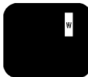
Trois sous-pixels adjacents allumés (un pixel blanc)
