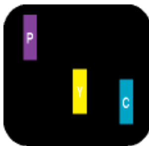
Dos subpíxeles adyacentes: - Rojo + Azul = Púrpura - Rojo + Verde = Amarillo - Verde + Azul = Cian (Celeste)
