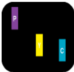
Twee naast elkaar gelegen verlichte subpixels: - rood + blauw = paars - rood + groen = geel - groen + blauw = cyaan (lichtblauw)
