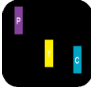
Zwei benachbarte erleuchtete Subpixel - Rot + Blau = Violett - Rot + Grün = Gelb - Grün + Blau = Zyan (Hellblau)
