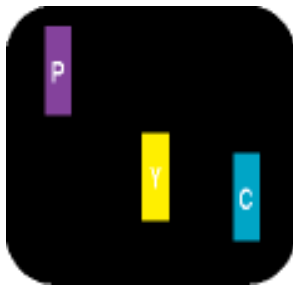
Twee naast elkaar gelegen verlichte subpixels: - rood + blauw = paars - rood + groen = geel - groen + blauw = cyaan (lichtblauw)
